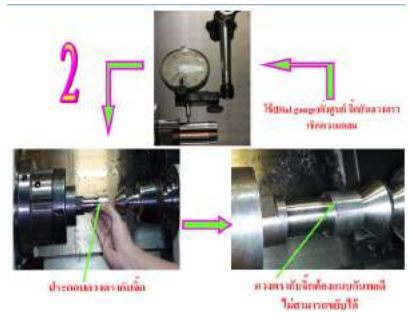
ภาพที่ 8 นวัตกรรมการกลึงดวงตราเหรียญจากแผ่นหมุนเวียนให้ได้นูน (Center)
