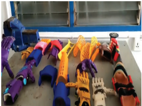
3D Printing สร้างกายอุปกรณ์เทียมมือ
